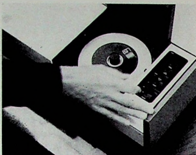
Bild 2. EVR-Teleplayer mit eingelegter Kassette und Bedienfeld
