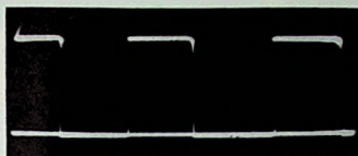
Bild 57. Wirkung einer Klemmdiode. Die Rechteckspannung liegt streng oberhalb der Nulllinie
