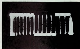
Bild 65. Vertikalsignal bei stärkerer Zeitdehnung
